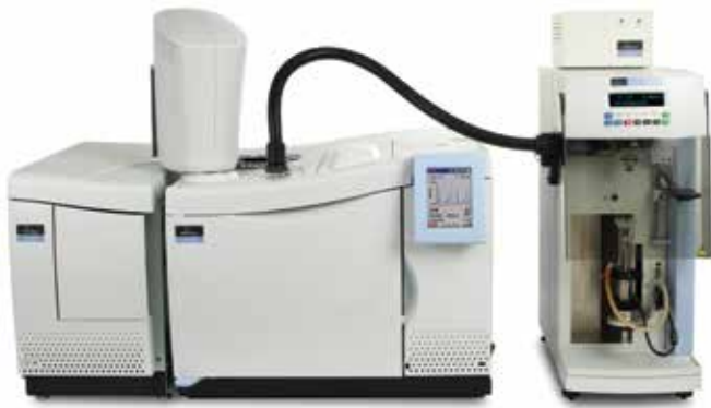
图1. Pyris 1 TGA 热重分析仪和Clarus 600 GC/MS联用系统是识别逸出气最灵敏的方法
